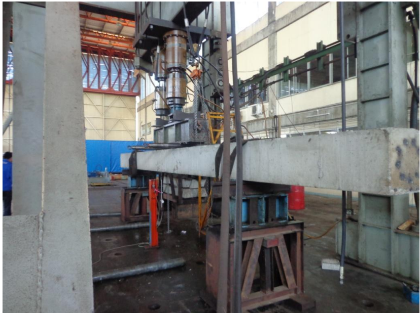
Gambar 5. Set up pengujian tiang pancang ( square pile )
